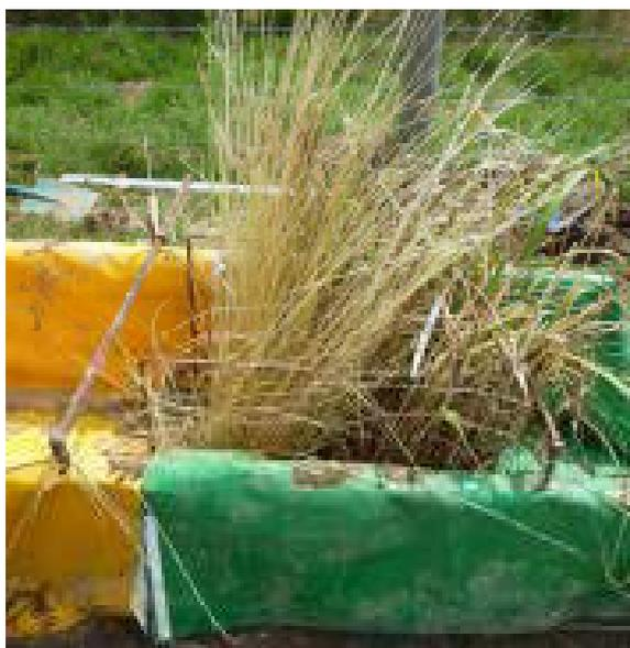
Figure 31 : le couple *Festuca mairei* -- *Miscanthus sinensis roland* en place dans le canal du simulateur de ruissellement (l'amont est à gauche).
