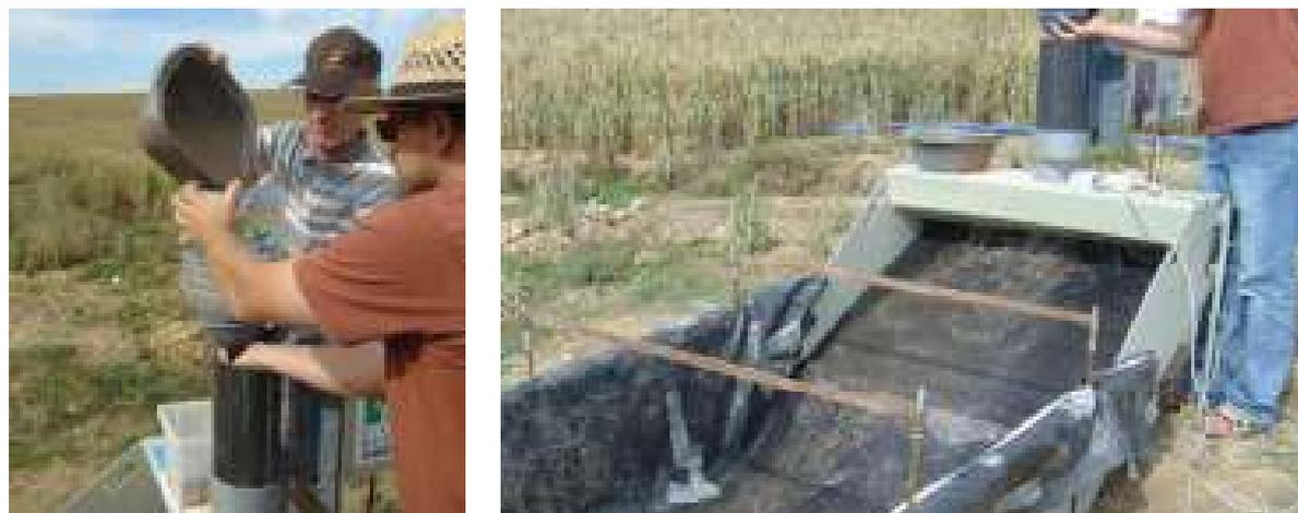
**Figure 18 : Apport des sédiments et homogénéisation dans le flux**
