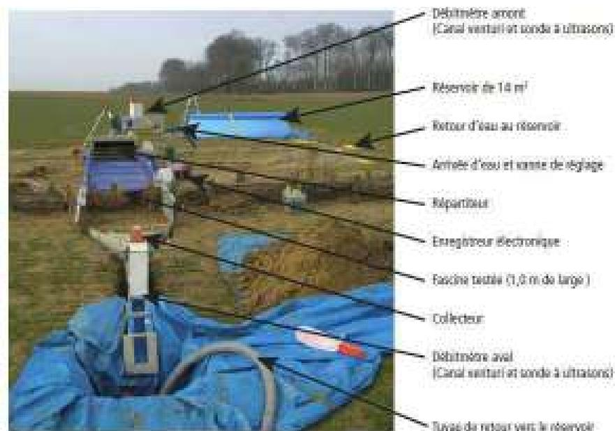
Figure 15 : Dispositif complet du simulateur de ruissellement vu depuis l'aval (installé sur une fascine à Saint-Gilles-de-la-Neuille)
